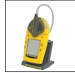
Ingebouwde pomp en batterijoplader
