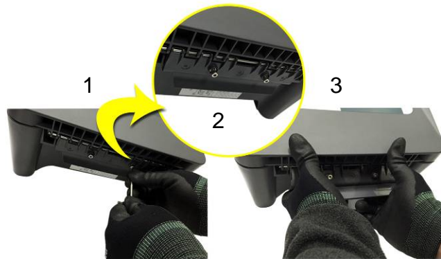
Afbeelding 10. De beveiligingsschroeven losmaken en de behuizing openen
