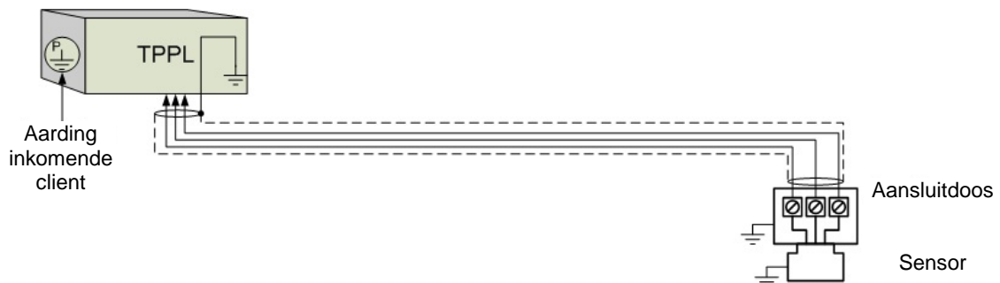
Afbeelding 26. Aarding voor afgeschermd kabel zonder bewapening, met metalen aansluitdoos en sensor
