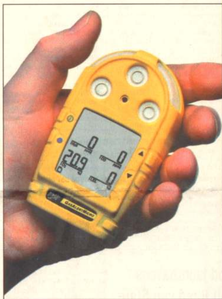
• De situatie is veilig. Het zuurstofgehalte staat op 20,9 procent en er worden geen schadelijke gassen gemeten. Dergelijke apparaten kosten 1000 tot 1500 euro.
